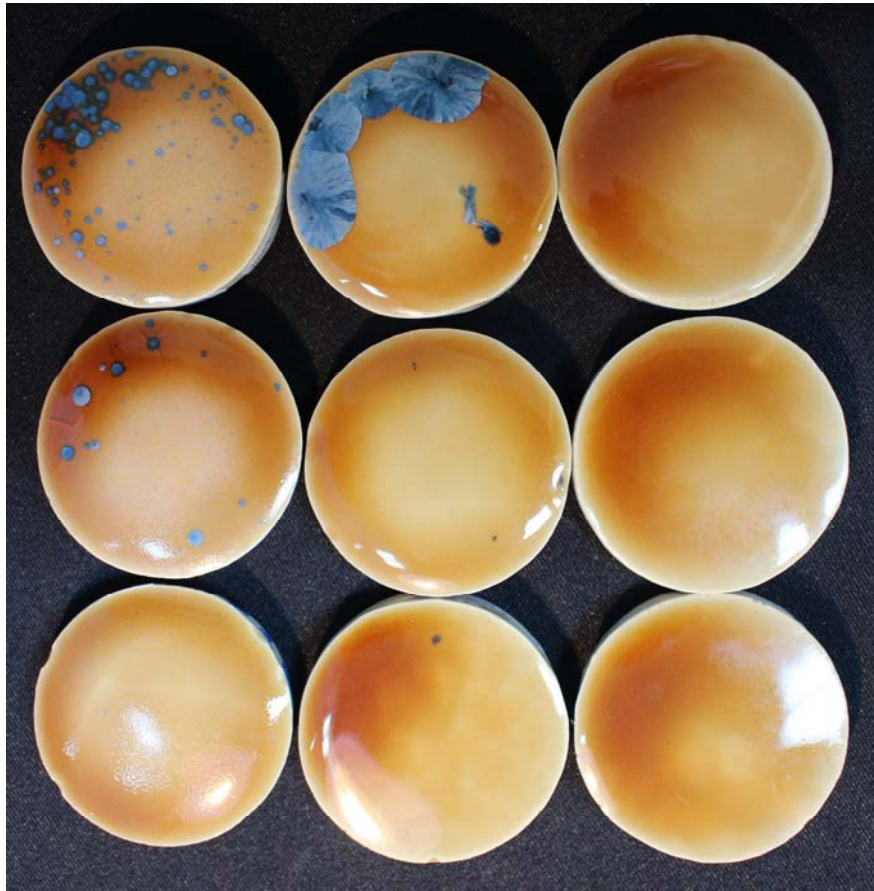
รูปที่ 1 : การเกิดดอกผลึกบนเคลือบใสระบบ ระบบ \text{Na}_2\text{O-SiO}_2\text{-Al}_2\text{O}_3\text{-CaO-ZnO} โดยมีเวลาการเผาแช่คงที่ที่ 8 ชั่วโมง ที่อุณหภูมิต่างกัน (แนวตั้ง) คือ 1000, 1100 และ 1200 °C (จากซ้ายไปขวา) และมีการเปลี่ยนแปลงสัดส่วนปริมาณสารช่วยหลอม (เพิ่มขึ้นจากแถวบนลงล่าง)
